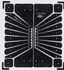
Fig. 1. IC-bordje Q9 op de helft van de ware grootte, gezien op de koperzijde.
