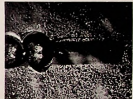
Afb. 4c. Snede uitgevoerd bij te grote vermogensdichtheid, vertoont het optreden van thermische breuken; 220 x vergroot.
