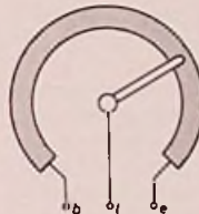
Fig. 73. Principe van een draaiweerstand.
